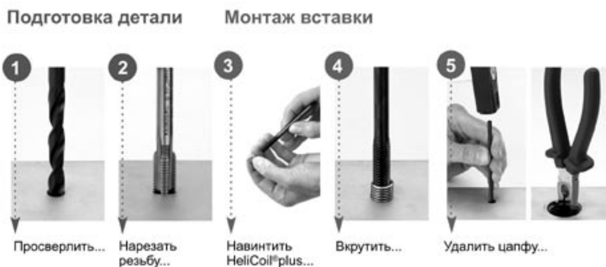
Рис. 4. Процесс установки резьбовой вставки HELICOIL®plus
